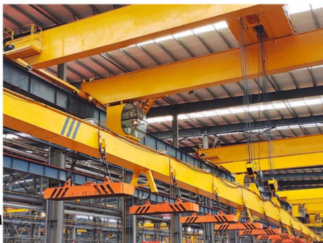
Мостовой кран с электромагнитом типа QC в основном оснащены электромагнитами. При подаче тока электромагнит позволяет прочно притягивать стальные грузы и поднимать в заданное положение. При отключении тока, магнетизм исчезает, и стальные грузы опускаются на землю. Такой кран в основе применяется на заводах для утилизации отходов и на металлургических заводах.
