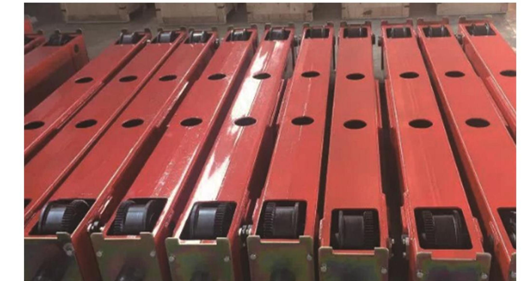
Концевая балка мостового крана состоит из колес, двигателей, буферов, станины, соединительных пластин балки, болтов и т.д. Для концевой балки принимаем прямоугольное управление модульного производства на фрезерном интегрированном настроенном станках с ЧПУ для завершения открытия, расточки, фрезерования и сверления в одно время. Концевая балка оснащена редуктором и приводом через полый вал. Эффективность работы высокая и диапазон регулирования скорости широкий.
