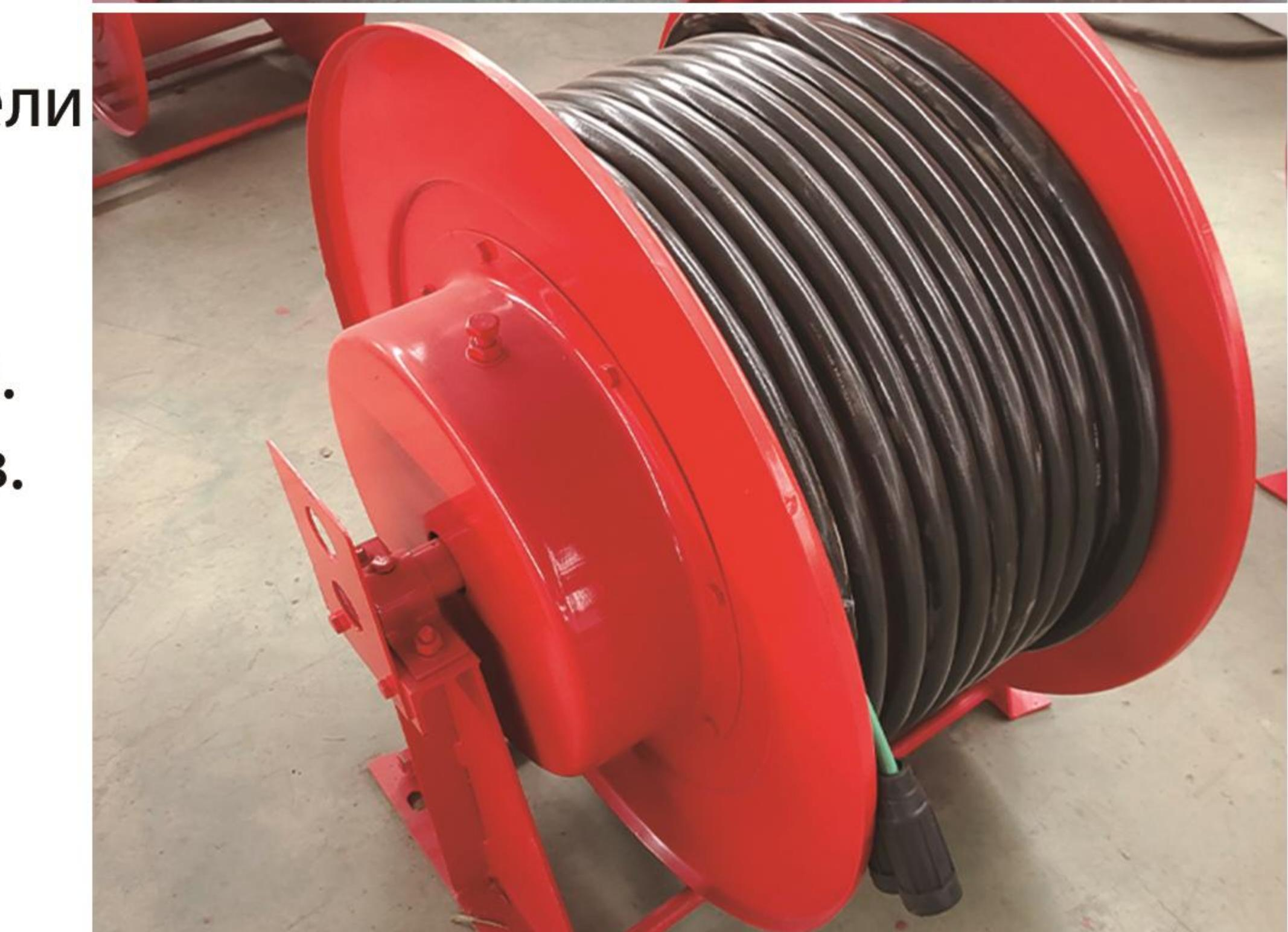
Кабельные барабаны серии JT - это механическое устройство, использующее распространенную во всем мире технологию намотки кабельных барабанов. Сматывание кабеля осуществляют приводные пружины при движении потребителя электроэнергии по направлению к барабану.
